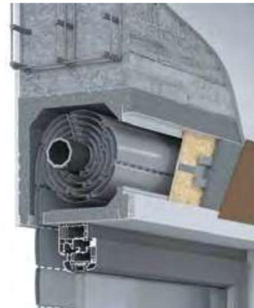
Cassonetto fornito di sistema di ispezione brevettato, in grado di consentire l'applicazione e la rimozione del tappo tramite una banda magnetica, senza necessitare di viti a vista per la sua tenuta. Il cassonetto lascia intravedere solo un frontalino di chiusura di 4 mm per un effetto "quasi letteralmente" a scomparsa nella muratura con grande impatto estetico. Il tappo di finitura è pronto per essere tinteggiato con il colore della parete.
